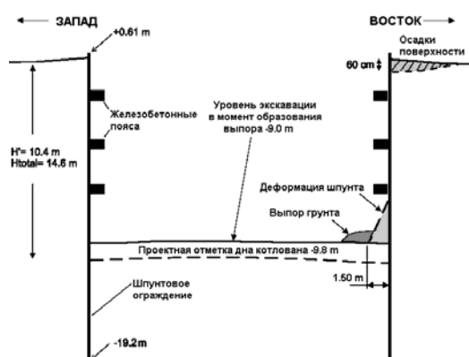
Рис. 9. Деформации котлована в Пуэрто-Рико (Crumley, 1998).
