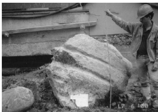
Рис. 5. Валун, извлеченный при устройстве котлована в Берлине (Kuntsche, 2007).
